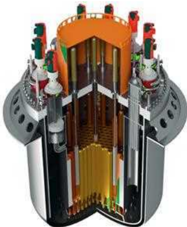
Рис. П2.14. Вариант компоновки реактора ALFRED проекта FALCON
