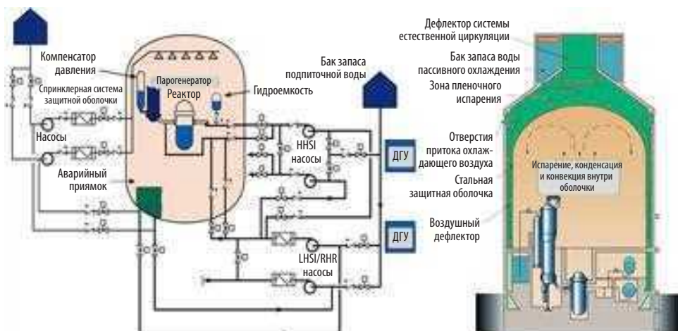
Рис. 3.15. Сравнение конфигураций систем безопасности типичного PWR (слева) и AP1000 (справа)
