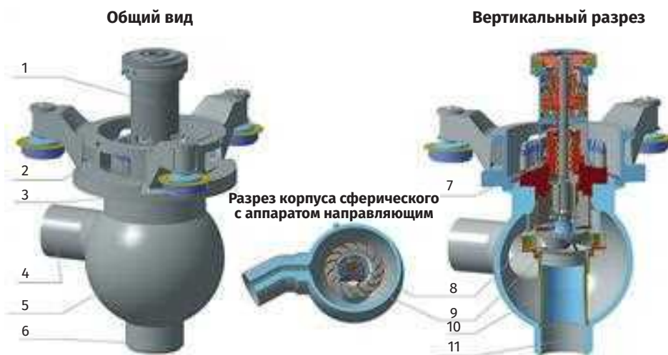
Рис. 2.17. Гидравлическая часть ГЦНА-1391.
