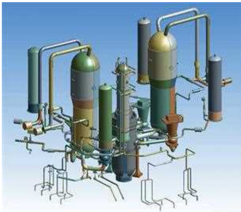
Рис. 3.49. Общий вид пространственной компоновки систем реакторной установки APR1400
