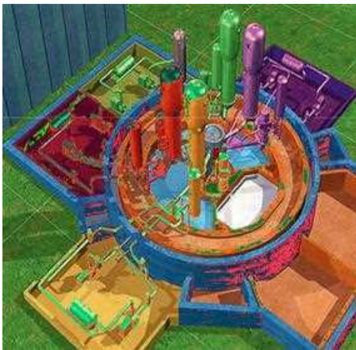
Рис. 3.41. Общий вид фундаментной плиты с оборудованием РУ и системой стабилизации расплава активной зоны EPR-1600
