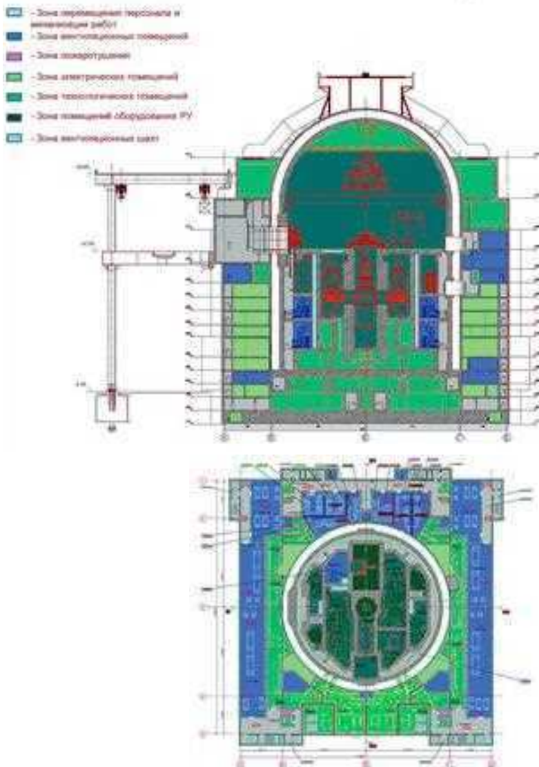
Рис. 2.86. Зонирование реакторного здания Кольской АЭС-2
