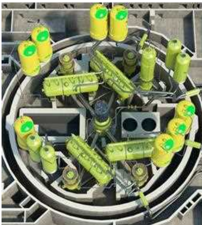
Рис. 2.1. Состав РУ ВВЭР-1200. Проект В-392М (НВАЭС-2)
