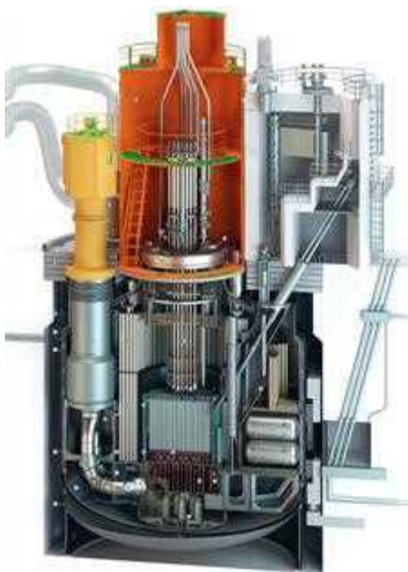
Рис. П2.27. Основные внутриреакторные элементы реактора БН-800
