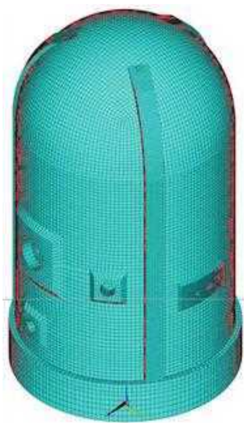
Рис. 3.77. Конструкция защитной оболочки реакторного здания APR1400 (RCB)
