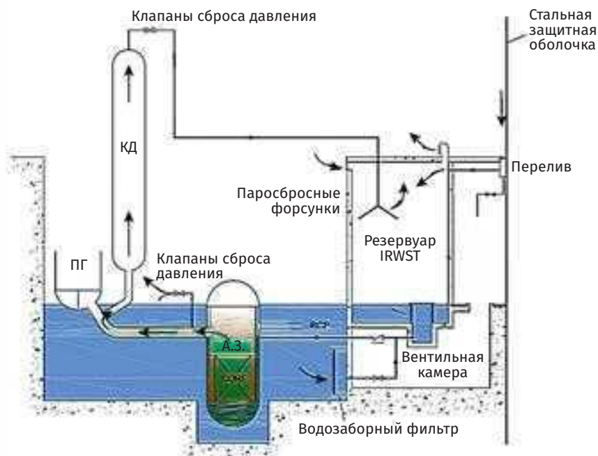
Рис. 3.21. Схема затопления отсеков для охлаждения корпуса реактора AP1000
