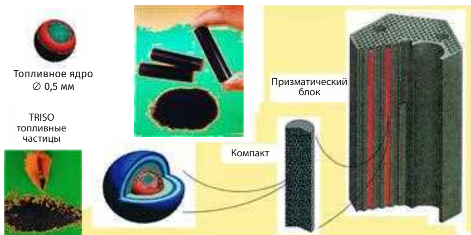
Рис. П2.40. Конструкция твэл призматического типа
