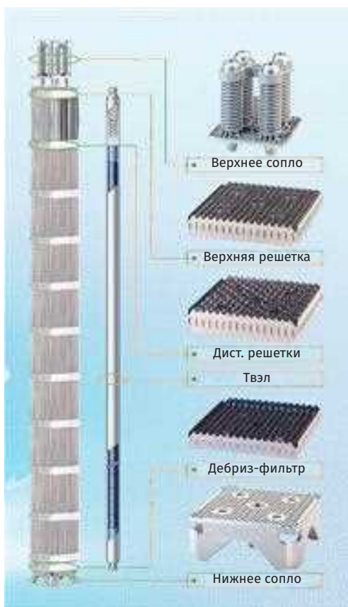
Рис. 3.62. Конструкция ТВС и элементов сборки реактора APR1400
