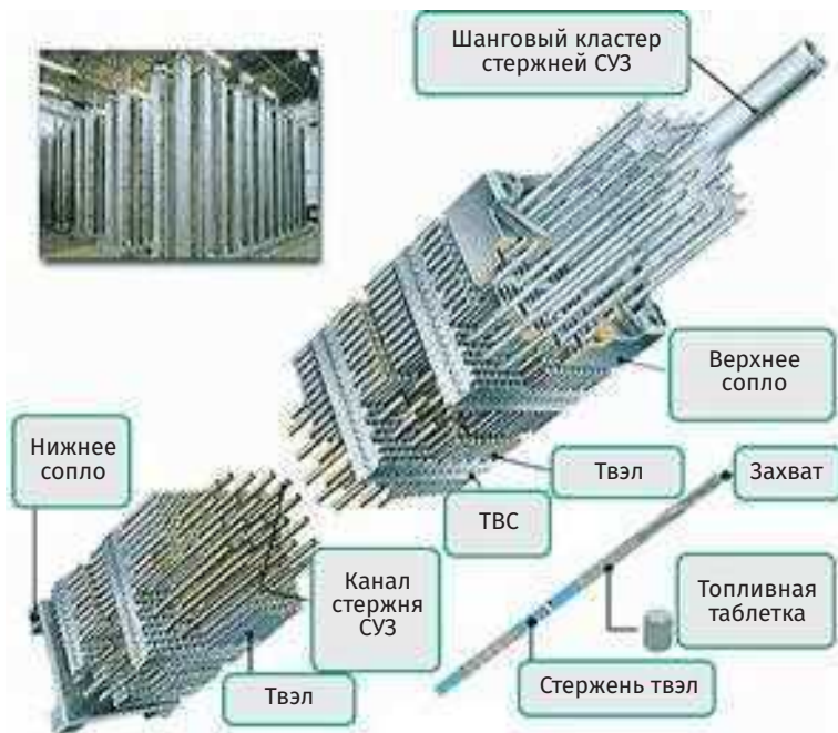
Рис. 3.7. Общий вид тепловыделяющей сборки, узла управления кластером регулирующих стержней ОР СУЗ и твэл реактора AP1000
