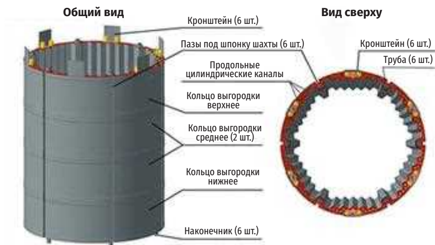
Рис. 2.7. Конструкция выгородки реактора ВВЭР-1200. Проект В-392М (НВАЭС-2)
