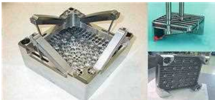
Рис. 3.34. Верхнее и нижнее сопла ТВС EPR-1600. Общий вид
