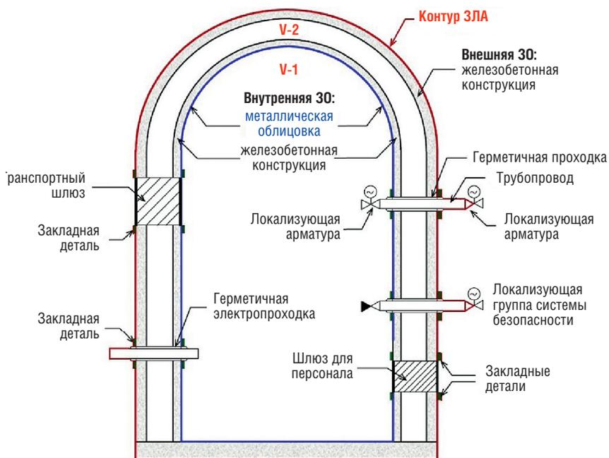
Рис. 3.24. Принципиальная схема ЗЛА ЛАЭС-2. Проект В-491 (ЛАЭС-2)
