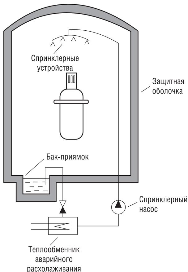
**Рис. 3.22.** Локализирующая система безопасности АЭС с ВВЭР-1000 (В-320).
