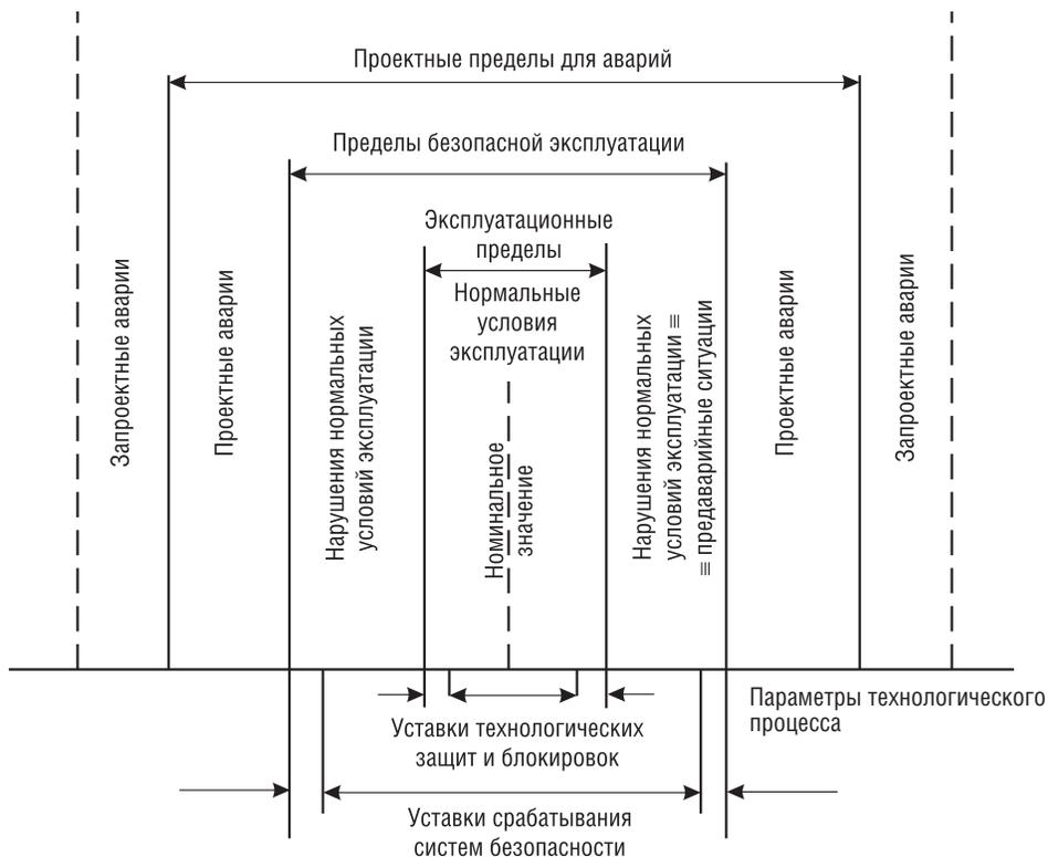
Рис. 1.3. Состояния и проектные пределы АЭС
