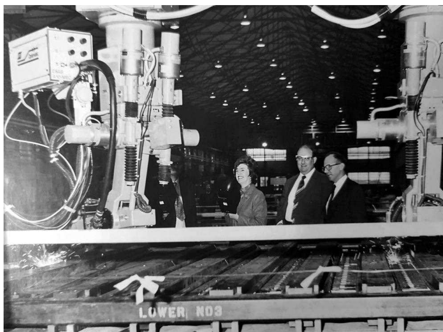
Посещение завода компании «Northern Engineering Industries», 1 октября 1981 г., выполнение сварочных работ с помощью роботизированного оборудования
