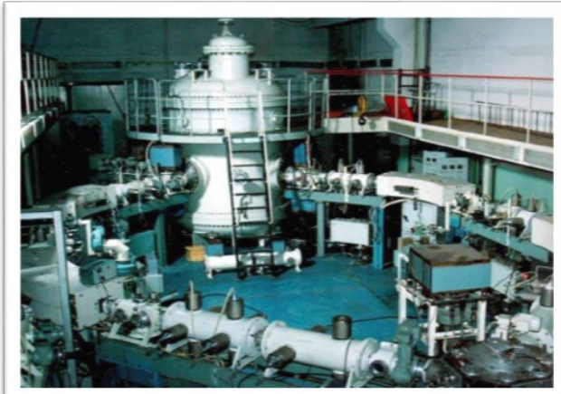
Электростатический перезарядный ускоритель УКП-2-1
