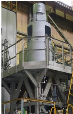
Раб. участок для испытания на воде полномасштабного макета радиально-осевого подшипника ГЦН-2
