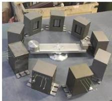
Датчики положения ротора электродвигателя ГЦН-2
