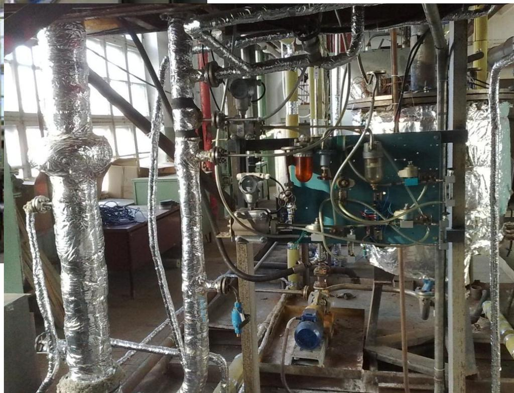
Греющая камера и циркуляционная труба выпарного аппарата АВ2 и система контроля и поддержания уровня
