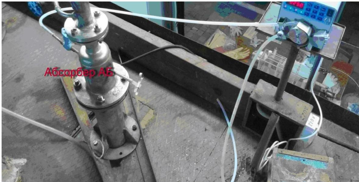
Верхняя часть абсорбционной колонны АБ и насос дозатор НП2
